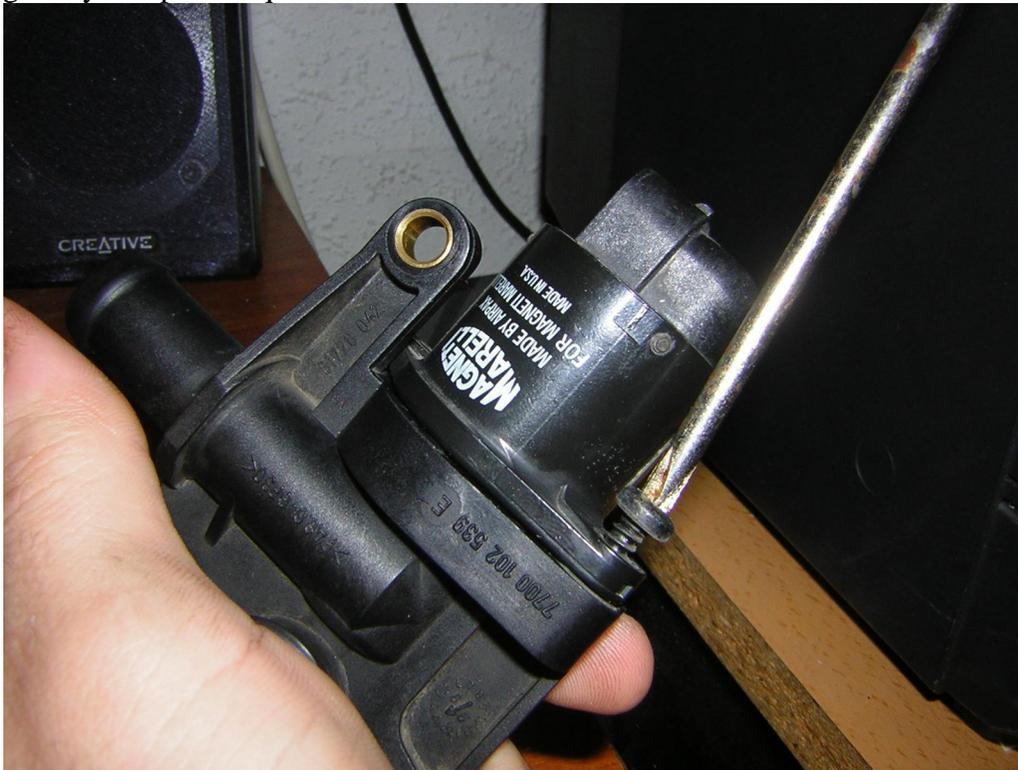
Procederemos a desatornillar los 2 tornillitos que la aguantan a la otra pieza de plástico con un destornillador de estrella normal y corriente se puede hacer este paso.
