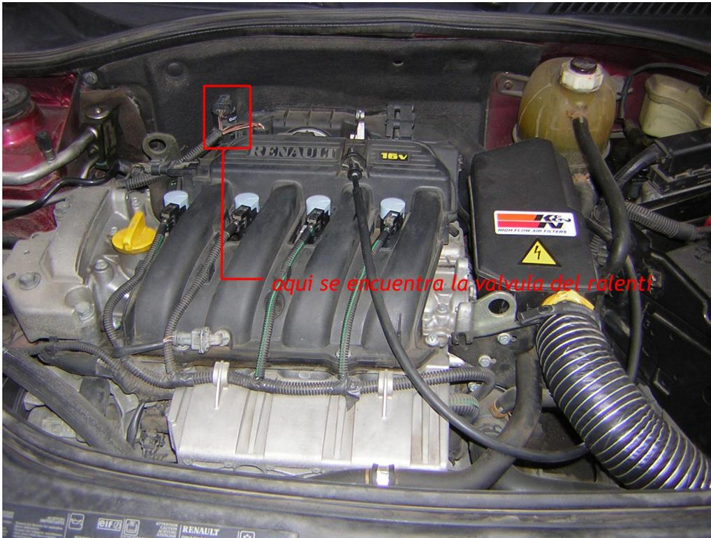
pues eso la válvula del ralentí esta ahí atrás, para empezar tendremos que desconectar los 2 conectores y el tubo de recirculación de gases para que sea mas cómoda la tarea. Con un destornillador o llave tipo torx quitaremos los 3 tornillos que la sujetan y saldrá fácilmente (los tornillos van sujetos en los agujeros dorados de la foto de abajo).(tened cuidado con la junta de goma que a veces se queda dentro, solo hay que quitarla con la mano y listos.
