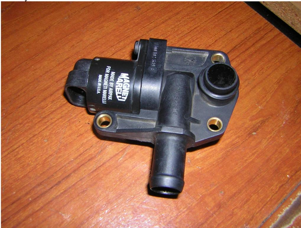
Aquí tenemos la famosa válvula desmontada y lista para la limpieza, revisad las juntas de
